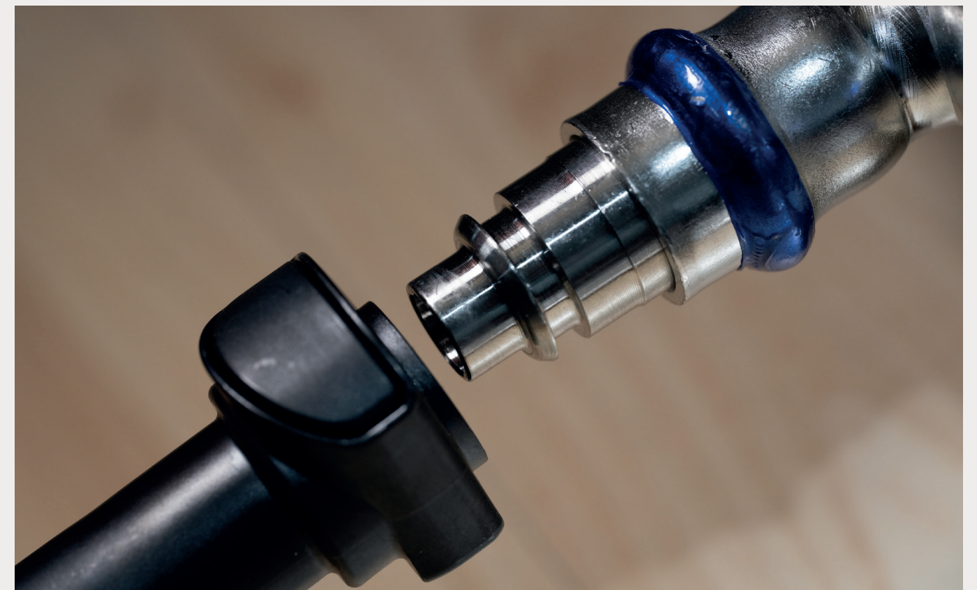
Abb. 10: Anbringen des Anschlusschlauches am Rohrleitungssystem
